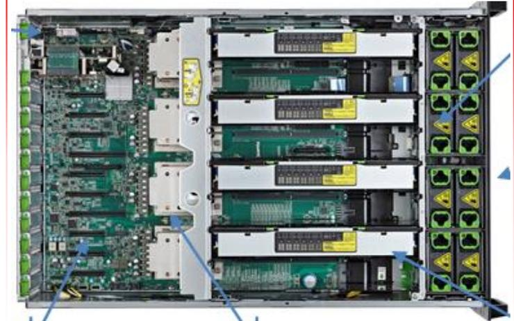
SU300B Systemboard mit 4 Prozessoren, Memory Boards, Festplatten, 10 PCI-Steckplätzen, redundanten Lüftern und Stromversorgungen
